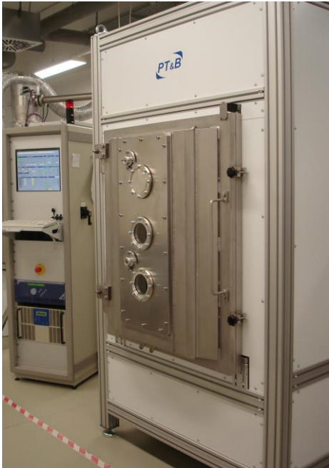
Bild links: STARON 80-100 inklusive Einhausung mit abgesetzter Steuer- und Versorgungseinheit.
